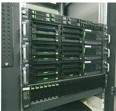
↑仮想化により統合されたサーバ。以前はラック内に物理的空きスペースはなかったが、現在はさらに4台のサーバを追加できる余裕が生まれている。
