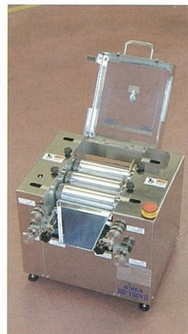
左：迅速なデータ収集が可能でコストパフォーマンスに優れた「RMB型バッチ式レディーミル」。 中央：「rBOM」の導入により、データの一元化が実現し、リアルタイムでの部品の在庫情報や生産状況などを把握することが可能に。 右：少量の試料の混合・練肉・粉碎・分散に使用可能な「BR-150VII型ロールミル」。
