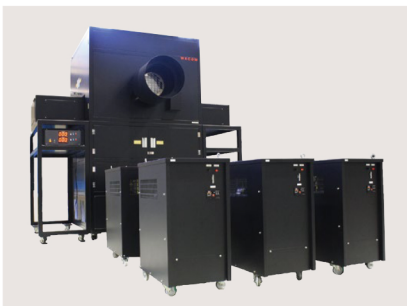
PVモジュール出力特性検査用ロングパルスソーラシミュレータ
