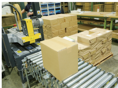
ピッキングされた荷物を封緘する専用マシン。同社の業務は、手作業とオートメーションが融合している。
